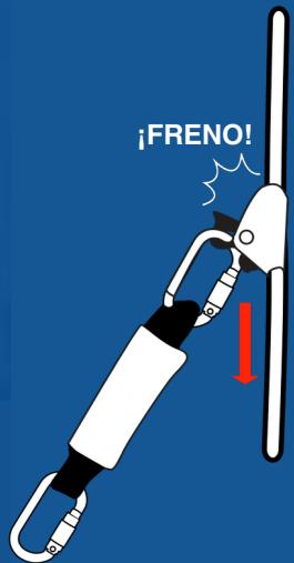
El freno de la línea de vida vertical, en caso de una caída, se activa automáticamente prensando la cuerda, lo que evita que el usuario caiga.
